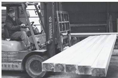
②製材所にて。使う材寸に合わせて丸太を挽きます。梁になる材を運ぶ金泉さん。
