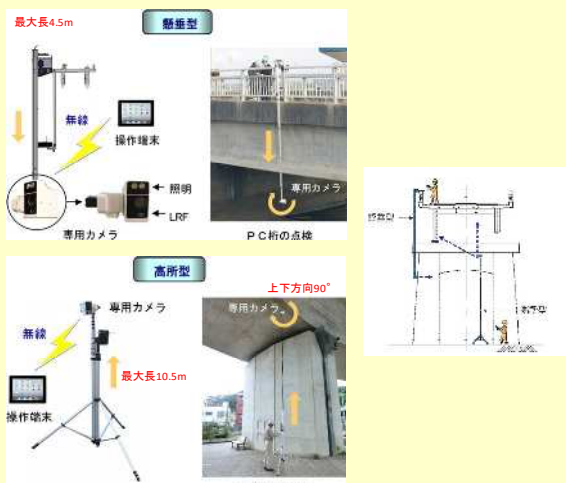
【BR010019-V0120 橋梁点検ロボットカメラ】
