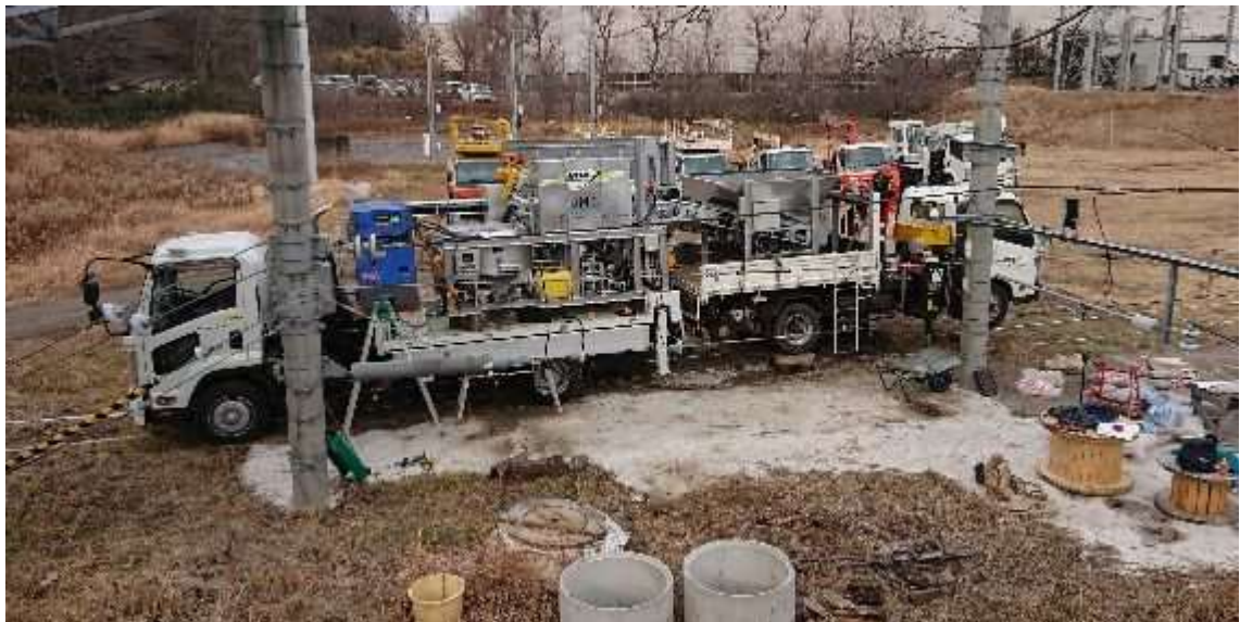
写真－７ 本体装置と骨材供給ホッパーを搭載した車上仕様
