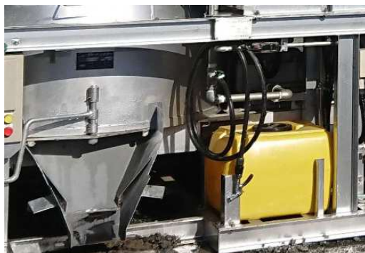
写真－３６ 混和剤タンク
