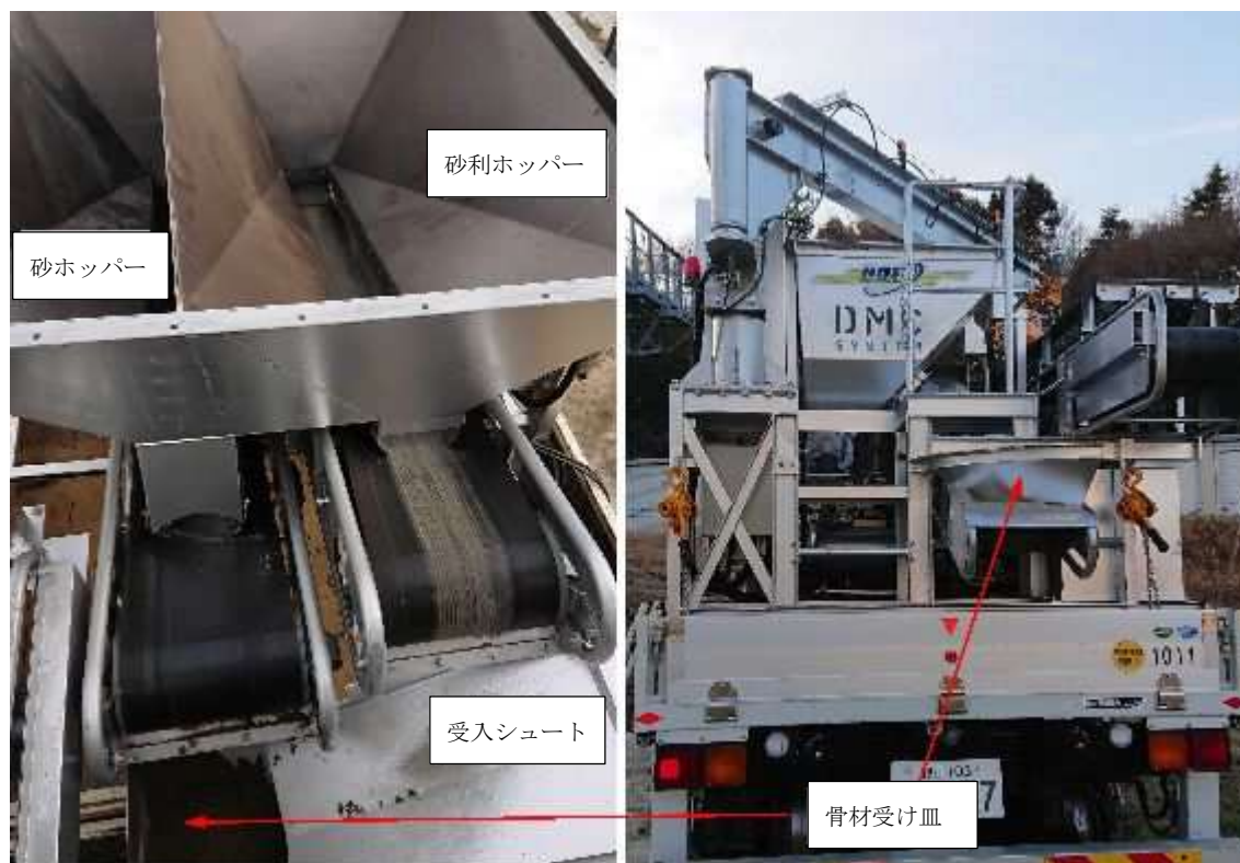
写真-5 骨材供給ホッパーと本体装置後方
