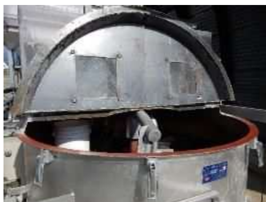
写真－３８ ミキサー上蓋の固定
