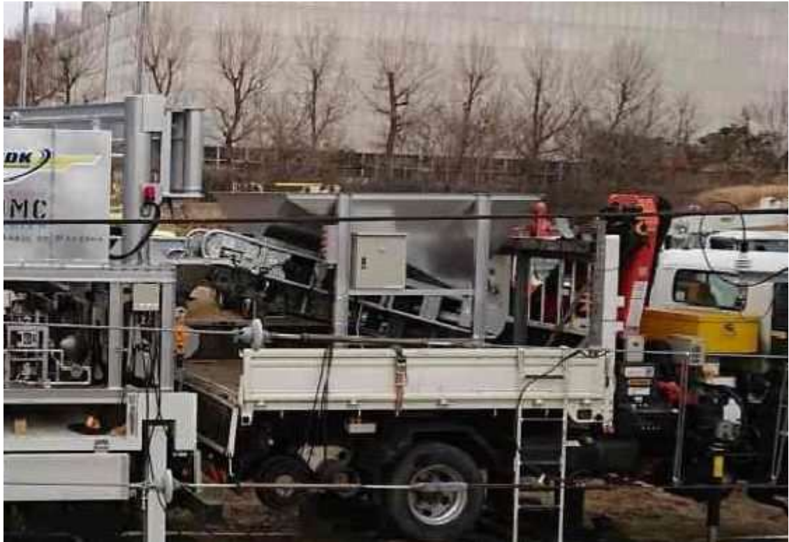
写真－６ 骨材供給ホッパーを搭載した車両風景
