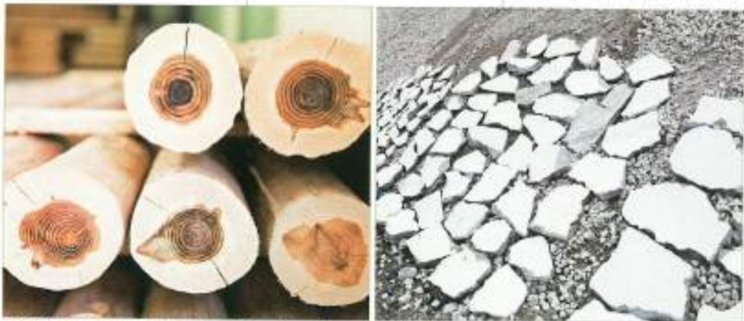
左/「鮎喰川コモン」の小屋組みに使われる予定のスギ材。右/「青雲寮」を解体した後のコンクリートから、用途ごとに大きさを選んで活用。
